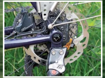
Die Syntace X-12 Steckachse versteift den Hinterbau und sorgt für einen präzisen, reibungslosen Lauf der Bremsscheibe.
