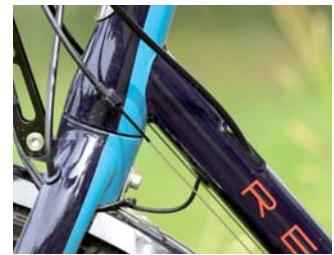
Gut geführt: Die Bremsleitungen verlaufen klapperfrei im Stahl-Rahmen.
