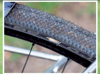
37 mm breit mit Mini-Stollen: Der Schwalbe G-One Reifen läuft leicht und ist griffig.
