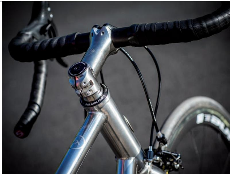
Die filigrane Optik eines Stahlrahmens ist ungewohnt, auch wenn heute Press-Fit-Tretlagergehäuse und Oversized-Steuerrohr dabei sind.
