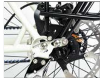
Das verstärkte Heck mit seinem vielseitigen Ausfallende.
