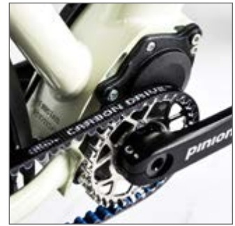
Der schräg eingebaute Pinion-Antrieb mit Gates-Riemen.
