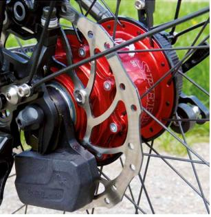
Die Rohloff-Nabe mit elektronischer Steuereinheit.
