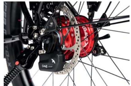
**Rote Rohloff Speedhub in E-14-Version, dank E-Stellmotor komfortabel schaltbar.**
