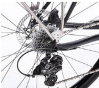
Vierkant-Kettenstreben und Steckachse für mehr Steifigkeit. Unten: Traumhaft leichtgängig schaltet Campas Record-Schaltwerk.
