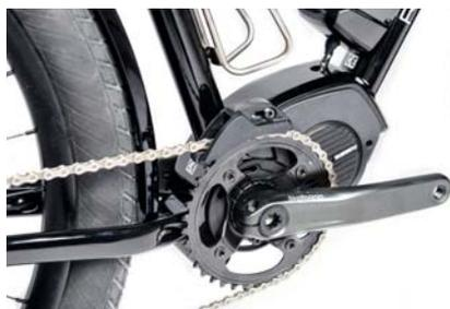
Shimano E-8000 Steps Mittelmotor mit 38er Kettenblatt und Führungsschiene.
