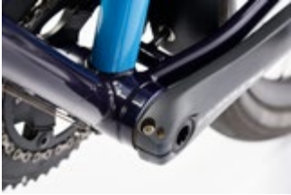
Im ausgedrehten Tretlager verläuft die Bremsleitung.
