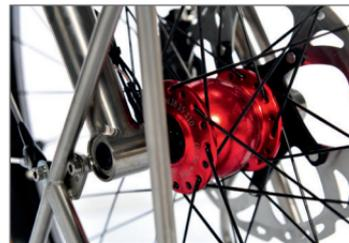
Der 110 mm breite Nabendynamo sorgt für steifere Laufräder und eine stabilere Gabel.
