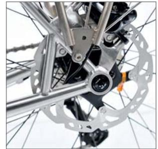
Die Steckachsen – und am Hinterrad auch die Verstrebung – sorgen für exzellente Steifigkeit.
