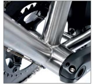
Der Edelstahlrahmen ist mit feinen Nähten gefertigt, hier am breiten Rennrad-Tretlager.
