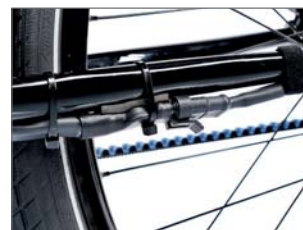
Die reversible Kabelmontage vereinfacht den Radausbau sowie einen kompletten Systemumbau.
