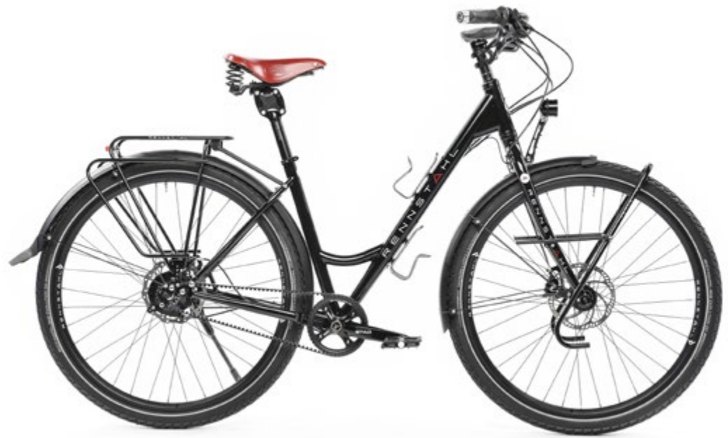
Komfort-Kombi: Brooks-Ledersattel u. Parallelogramm-Federstütze.
