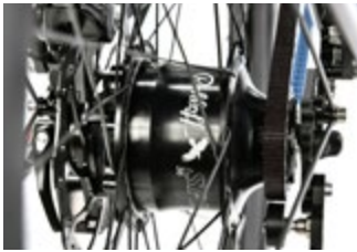
Gekapselt, 14 Gänge: Rohloff Getriebe stark auch für Touren.
