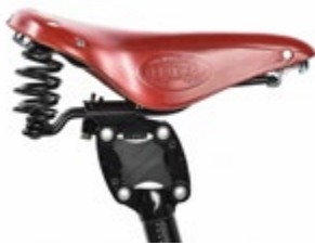
Komfort-Kombi: Brooks-Ledersattel u. Parallelogramm-Federstütze.
