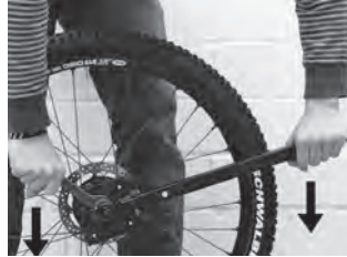
Abbildung 5: Festziehen des Rear Sprockets mit POM-Sprocket-Key und Maulschlüssel SW24 zum Gegenhalten des Rohloff Abziehers
