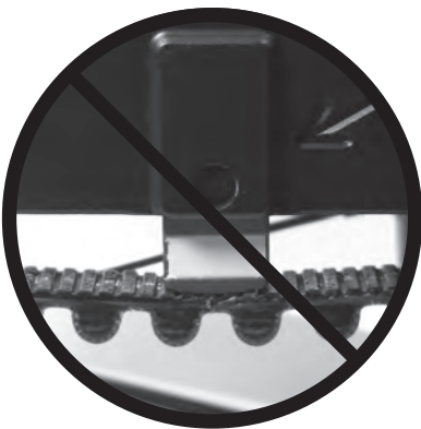
Abbildung 1: Falsche Riemen ­ spannung
