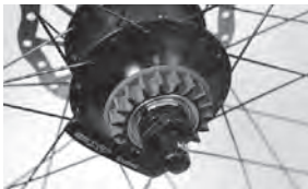
Abbildung 2: Sichern des Rohloff Ritzelabziehers durch Schnellspanner oder ggf. Achsmutter
