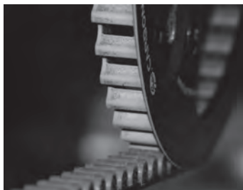
Abbildung 2: Abnutzung der produktionstechnisch bedingten blauen Schicht
