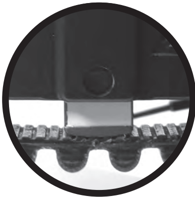
Abbildung 3: Optimale Riemen Spannung
