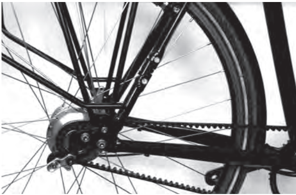
Abbildung 3: Beispiel zur Rahmenkonstruktion: Teilung der Sitzstrebe
