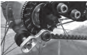
Abbildung 1: Rohloff SPEEDHUB 500/14 mit Snubber
