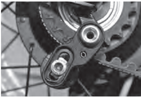
Abbildung 3: Seitenansicht des montierten Snubbers
