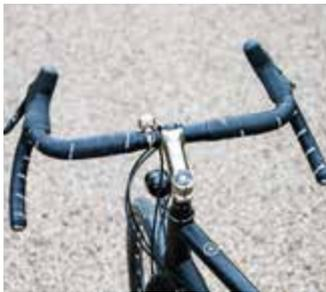
Gebra Rohbox ermöglicht die Kombination Rohloff und Rennradhebel. Unten: Top Ergonomie und Komfort: der ausgestellte Lenker.
