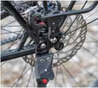
Aus einem Block geschmiedete und gefräste Pinion-Brücke. Unten: Stabiles Steckachsen-Ausfallende mit kompletter Integration.
