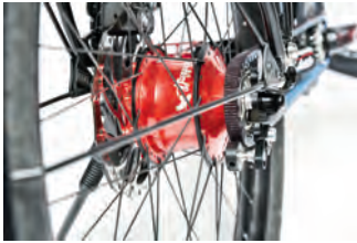
Rohloff: elektronisch schaltbar, breite Entfaltung mit kleinem Berggang.
