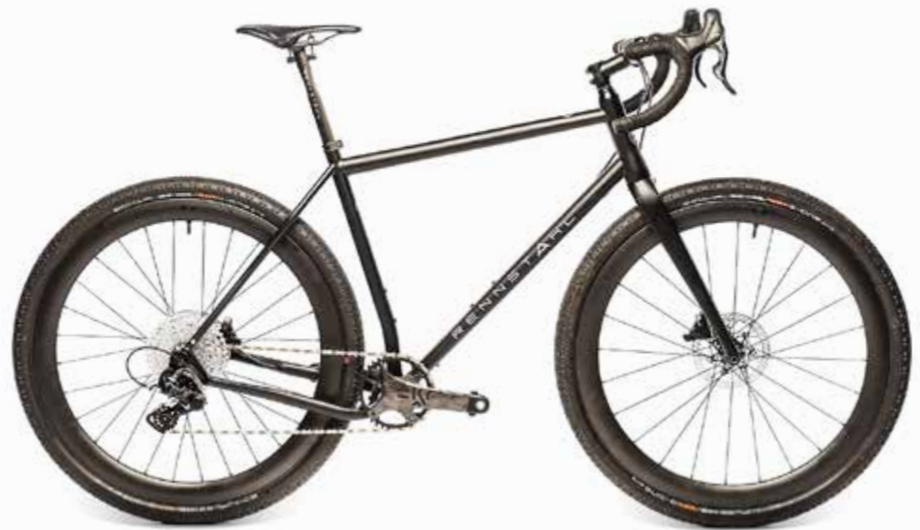
Das edle Campa-Ekar-Schaltwerk steuert 13 Ritzel an. Unten: Formschön und geordnet: Zuginnenverlegung am Top-Stahlrahmen.
