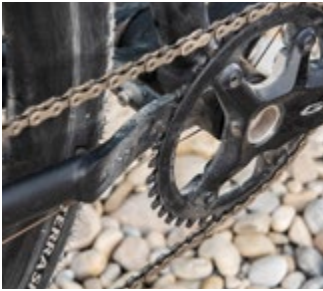
Die sehr direkte Carbonsattelstütze mit allen Montageoptionen. Unten: Das Schmiedeteil bringt Raum für Schaltung und Breitreifen.
